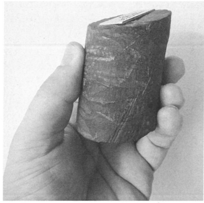
Das tiefste Stück Österreichs aus ca 8550 Metern Tiefe: Ein Bohrkern von der Tiefbohrung Zistersdorf vom Mai 1983. .
